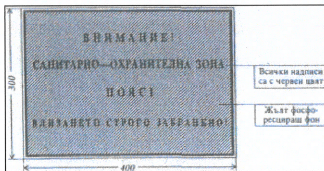
Предупредителна табела на пояс I на санитарно-охранителната зона
